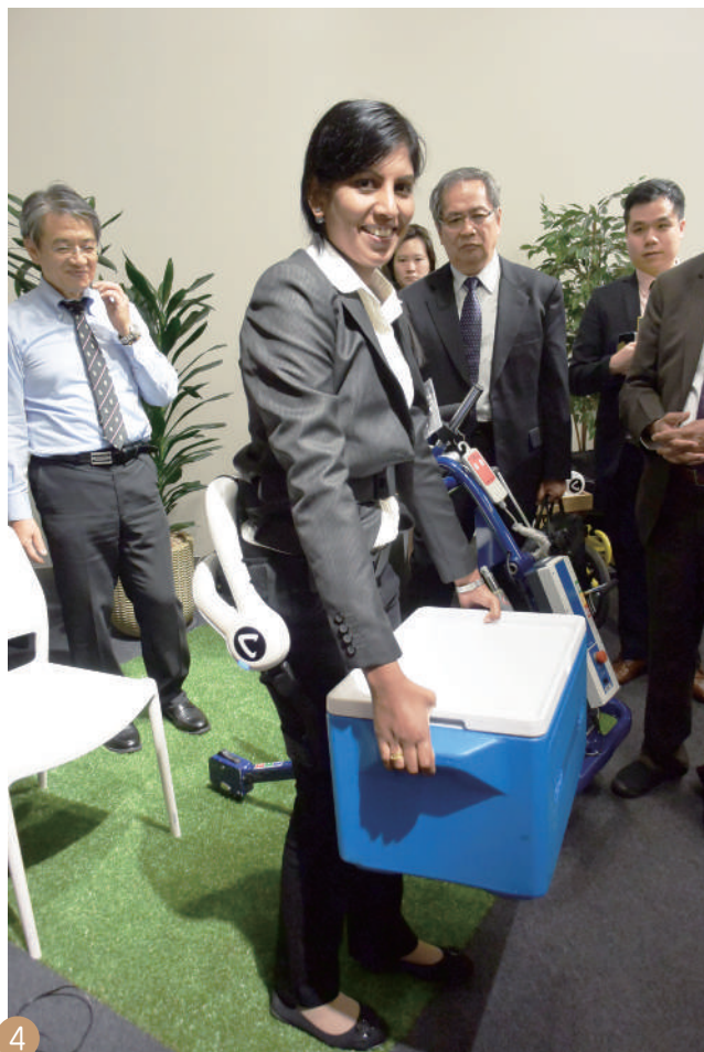
④ (大和ハウス工業) 展示場にて様々な福祉機器を実際に試着する。HAL® 腰タイプ介護支援用は、移乗介助のような介助動作において腰部にかかる負荷を低減することで、腰痛を引き起こすリスクを減らす
